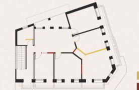
PLANTA DEMOLIR CONSTRUIR PAV. pav. superior escala 1:250
