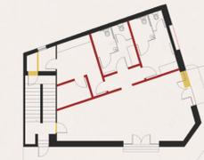
PLANTA DEMOLIR CONSTRUIR PAV. TÉRREO escala 1:250
