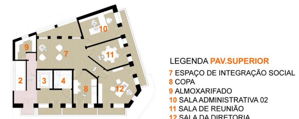
PLANTA BAIXA PAV.SUP. | ESC. 1:250 PROPOSTA EDIFÍCIO PAU DO MEIO
