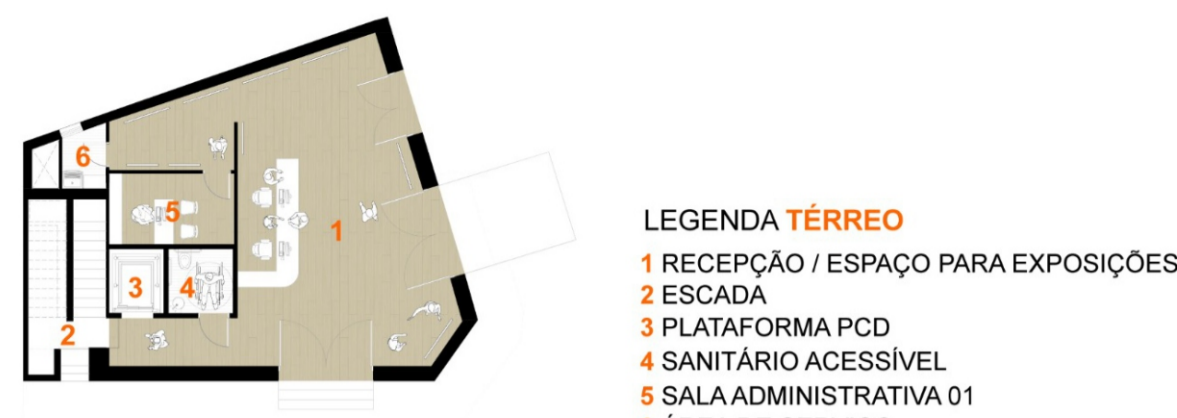
PLANTA BAIXA TÉRREO | ESC. 1:250 PROPOSTA EDIFÍCIO PAU DO MEIO
